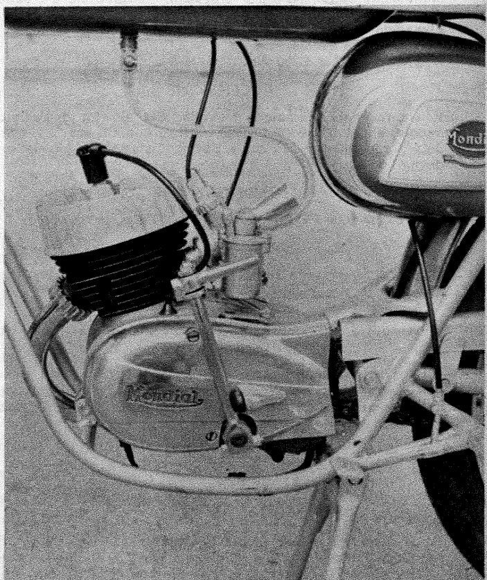
ore cambio, anch'esso di linea nitida e funzionale. Notare l'abbondante alettatura della testa, l'inclinazione del carburatore del cilindro interrotta attorno alla zona dello scarico. Si vede anche il pozzetto centrale del serbatoio, che consente l'uso ribinetto.
